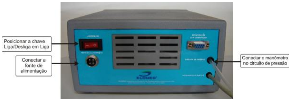
Figura 7 Conexões dos cabos
