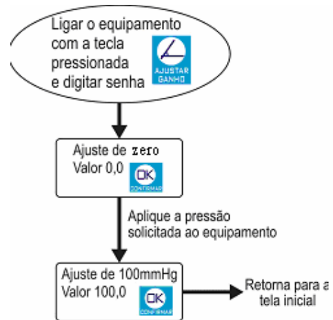
Figura 18 Fluxograma para ajuste de erro de ganho do calibrador de pressão
