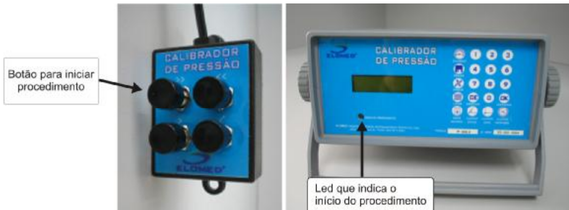
Figura 9 Detalhe do botão a ser acionado para iniciar a calibração e led de sinalização de “início de procedimento”
