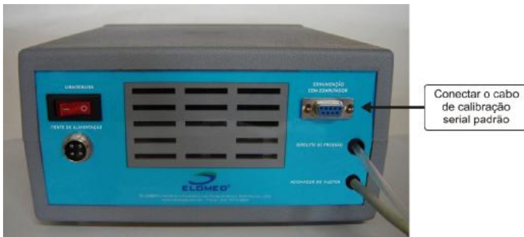
Figura 16 Conexão com o computador através da porta serial.
