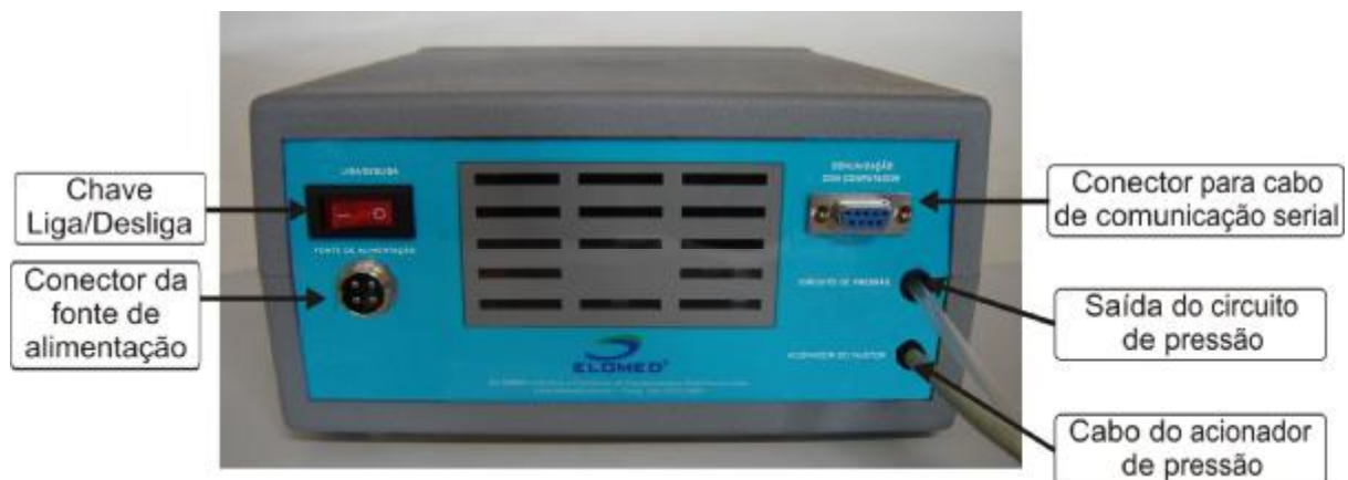
Figura 3 Vista da parte de trás do calibrador de pressão e descrição das partes
