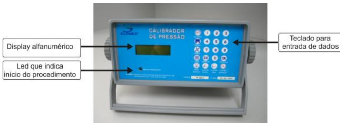
Figura 1 Calibrador de Pressão com detalhes do display alfanumérico, teclado para entrada de dados e led sinalizador de funcionamento.
