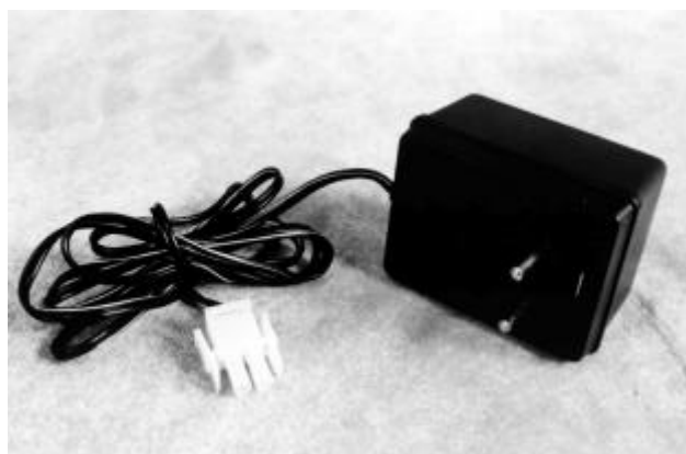
Figura 3 – Fonte de tensão 220V/ 110V para carga da bateria
